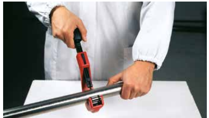
Fig 25 - Kapa rör till rätt längd
